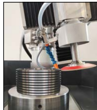
Affilatura controlama multipla con prolunga e mola frontale a disco
