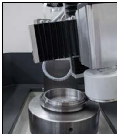
Affilatura controlama singola con mola frontale (opzionale)
